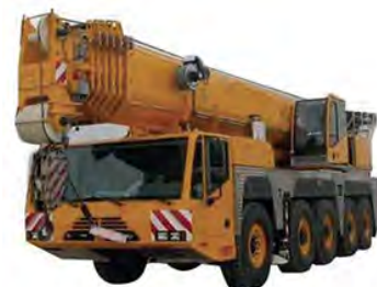
Demag AC-200 Cap. 200 t Altura máx. Boom: 68 m Altura máx. tele + Jib: 100 m
