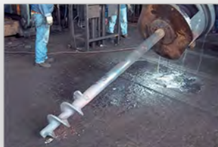
Reparación de tornillos alimentadores
