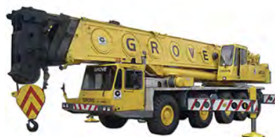
Grove AT 1400 Cap. Máx: 140 t Altura máx. Boom: 43 m Altura máxima tele + Jib: 62 m
